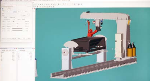
Links: Vera's lasprogramma voor een onderbak uit de Stratos 3-serie. Rechts: dezelfde onderbak, gehecht en klaar voor de lasrobot.
