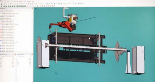
Links: een Stratos 3-onderdeel in Vera's lasprogramma. Rechts: de robot last precies zoals zij het heeft geprogrammeerd.
