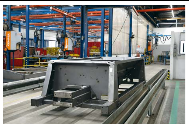
Links: Vera's lasprogramma voor een onderbak uit de Stratos 3-serie. Rechts: dezelfde onderbak, gehecht en klaar voor de lasrobot.
